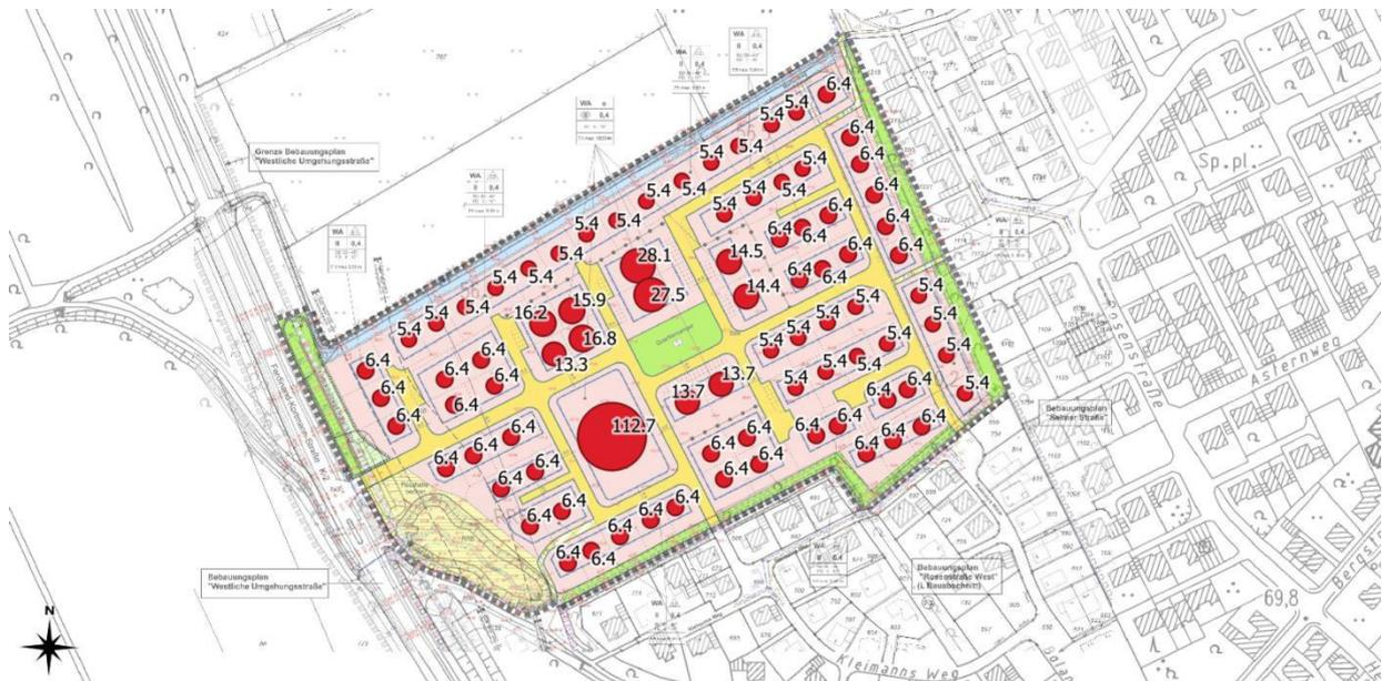
Abbildung 3 abgeschätzte Heizlast in kW der Gebäude bei KfW 55 / KfW 40
